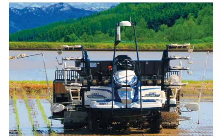
リモコン操作で無人作業ができるGNSS搭載ロボット田植機
