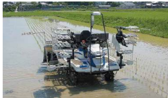
さらなる省力化が期待される有人監視型ロボット田植機
