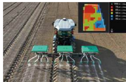
マップデータ連動可変施肥機種はJA全農が推進している「ザルビオフィールドマネージャー」のマップデータにも対応
