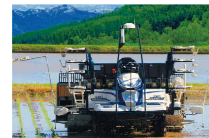
リモコン操作で無人作業ができるGNSS搭載ロボット田植機
