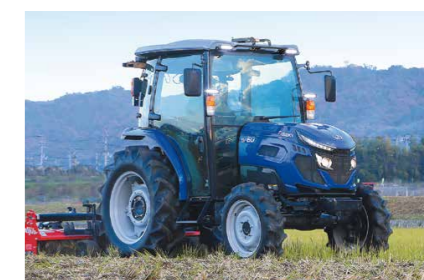
10年ぶりにモデルチェンジしたポリウムゾーンの中型トラクタBFシリーズ（直進アシスト機能搭載）
