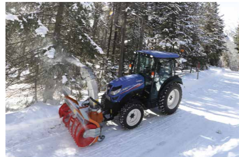
スノーブロワを機体前方に取り付け除雪作業を行うトラクタ
